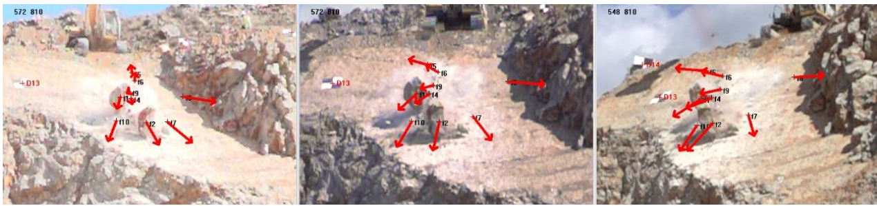
Figura 3. Muestra de tres fotogramas tomados en el mismo instante con los vectores proyectados de las velocidades de distintos fragmentos del bloque #15.
