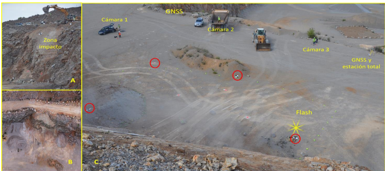
Figura 2. Esquema de la zona del experimento. En A se muestra la superficie donde impactan los bloques. B es una toma cenital de la zona. En C se muestra la disposición de las cámaras, el equipo topográfico y el flash. Marcadas en rojo se muestran algunas de las dianas dispuestas sobre el terreno.
