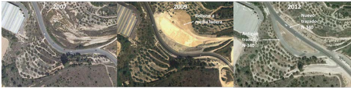
Figura 5: Ejecución del terraplén a media ladera para la eliminación de la curva de la N-340.
