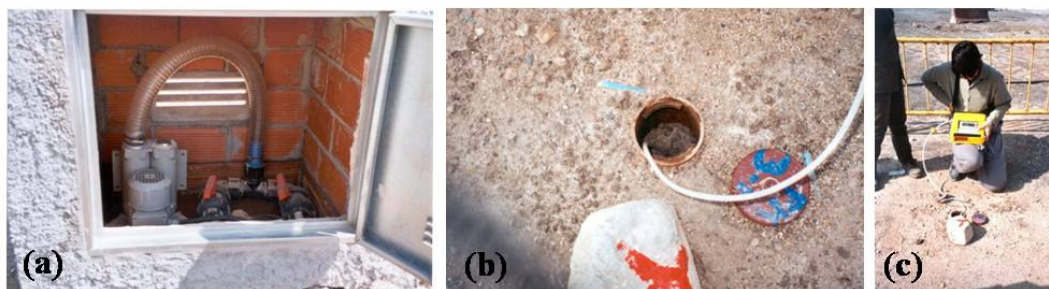
Figura 3. Ensayo piloto mediante la tecnología del bioventeo. (a) soplador, (b) sonda en piezómetro, (c) determinación de O_2 y CO_2 .
