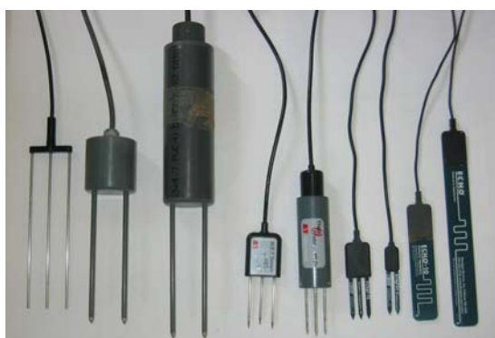
Figura 1. Sensores EM. De izquierda a derecha: sonda Trase, TRIME-P2 y EZ, WET Sensor, ML2x, ECHO-TE, EC-5, EC-10 y EC-20.
