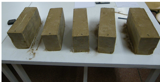
Fuente: Félix Jové. Lab.ETSA, muestras de BTCs para ensayos de compresión y succión de agua
